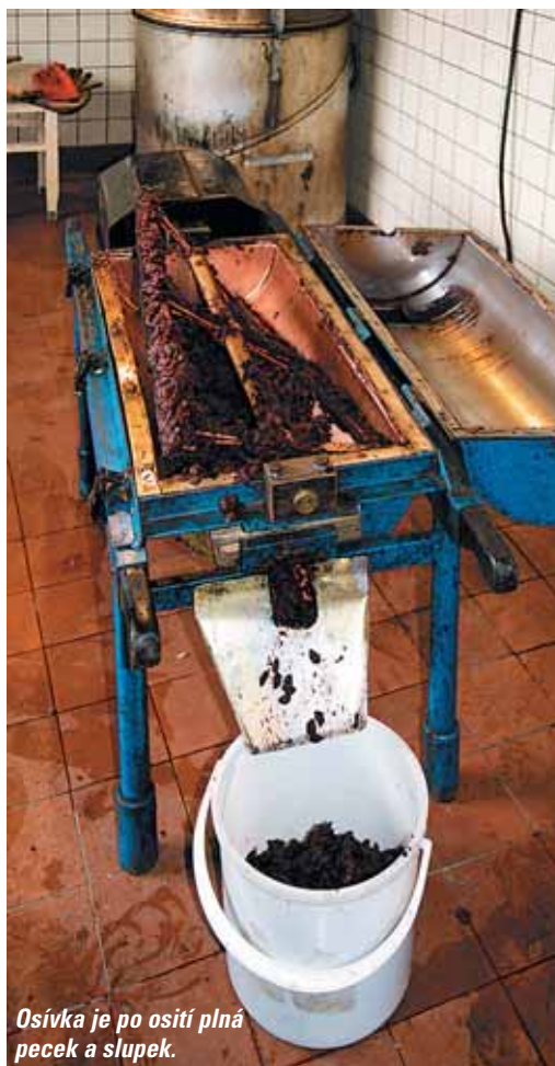
Po vyčištění osívky je vidět rám, který rozvařené švestky pasíruje přes síto.
