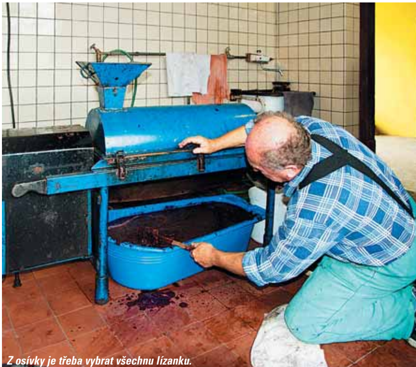
Po vyčištění osívky je vidět rám, který rozvařené švestky pasíruje přes síto.
